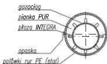
PRZEKRÓJ RURY OCHRONNEJ
