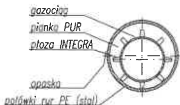
PRZEKRÓJ RURY OCHRONNEJ
